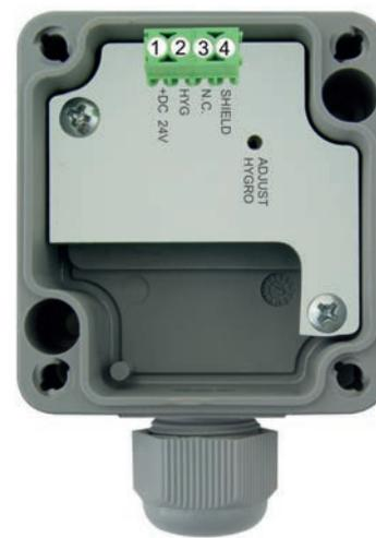
Der Pt1000 ist potentialfrei durchgeschleift, mit 2-Leiteranschluss. Der Leitungswiderstand ist zu kompensieren. Auf Wunsch sind auch andere Messwiderstände, beispielsweise NTC-Widerstände, möglich! Die Messung der Ausgangssignals sollte mit separater Signalmasse erfolgen, um Messfehler durch Spannungsabfall an der Versorgungs-masse zu vermeiden.
