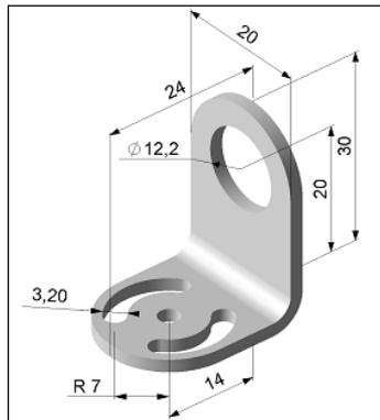
Abbildung 7: Montagewinkel, justierbar in einer Achse [Bestell-Nr.: ACCTFB]
