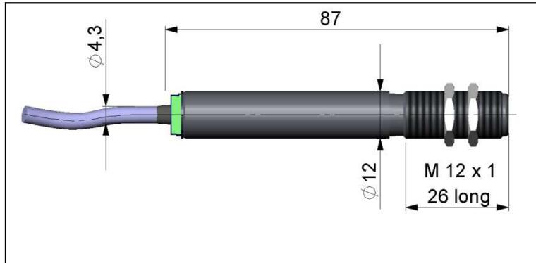
Abbildung 6: Abmessungen CS
