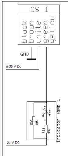
**Abbildung 23:** Direkte Ansteuerung von 24V-Signallampen über den Open-collector-Ausgang
