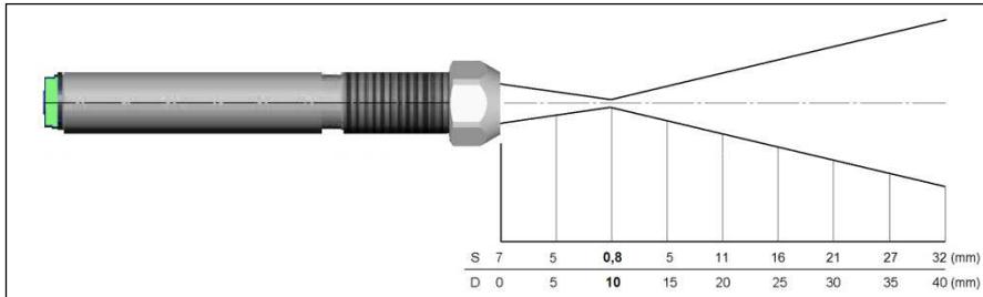
Abbildung 2: Optisches Diagramm CS (15:1) mit CF-Linse (0,8 mm@ 10 mm)
