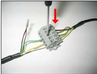
**Abbildung 20:** Anschluss USB-Adapterkabel
