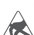
Der Sensor ist bei falscher Handhabung ESD gefährdet. Die üblichen Vorsichtsmaßnahmen für CMOS Schaltungen sind für die Handhabung des Bauteils jedoch ausreichend. Das Berühren der Signalausgänge sollte vermieden werden, bevor das Modul in die Trägerplatte eingebaut ist.
